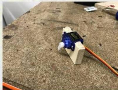
L'installazione sotto plancia è fatta in corrispondenza di un foro che permette il passaggio dell'asta di azionamento. Il servo con il suo supporto è incollato alla plancia
